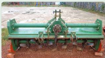
Máy xới và vùi rơm ruộng khô với độ sâu 10 – 15 cm
